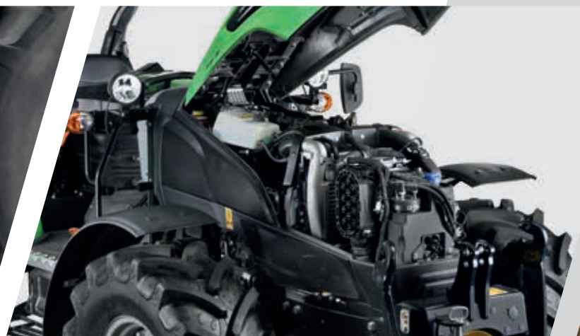
> Einfache Wartung dank der weit öffnenden Motorhaube.
