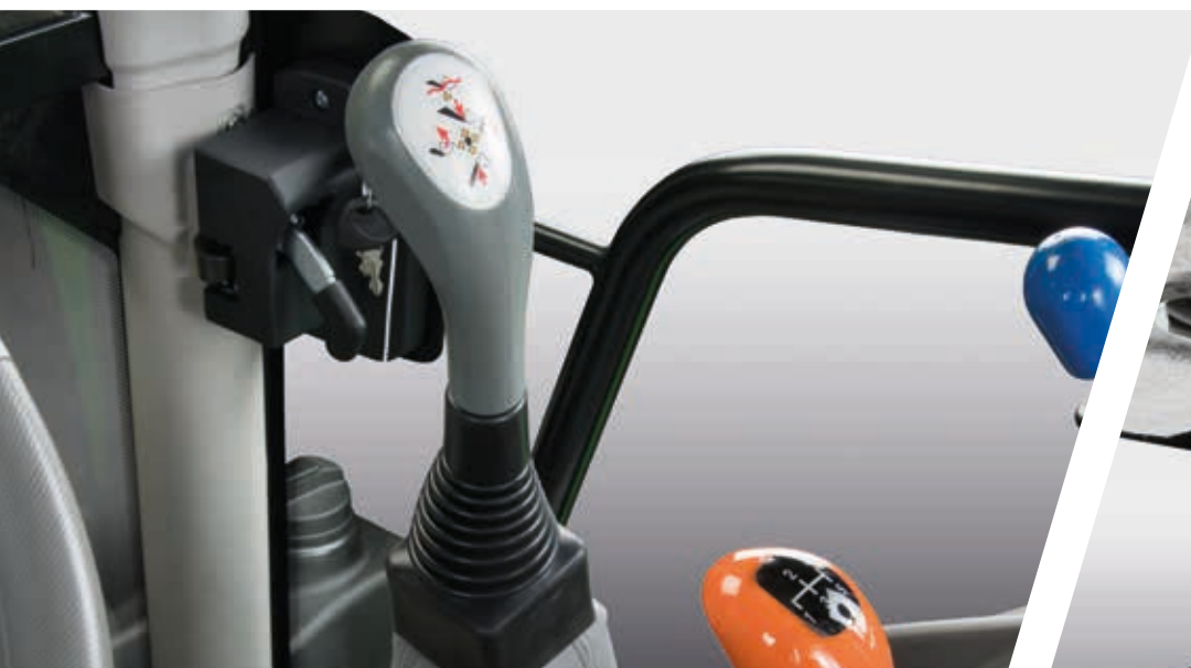
> Vollständig integrierter Frontlader-Joystick.
