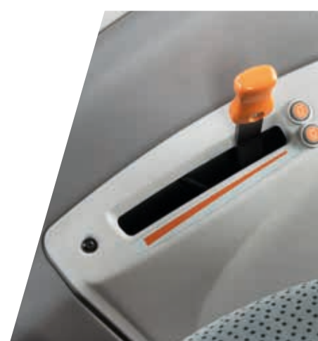
> Handgashebel mit zwei elektronisch speicherbaren Motordrehzahlen.
