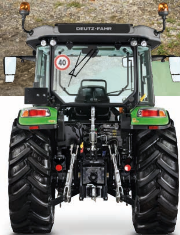
> Leistungsfähiger Heckkraftheber mit bis zu 3500 kg Hubkraft.
