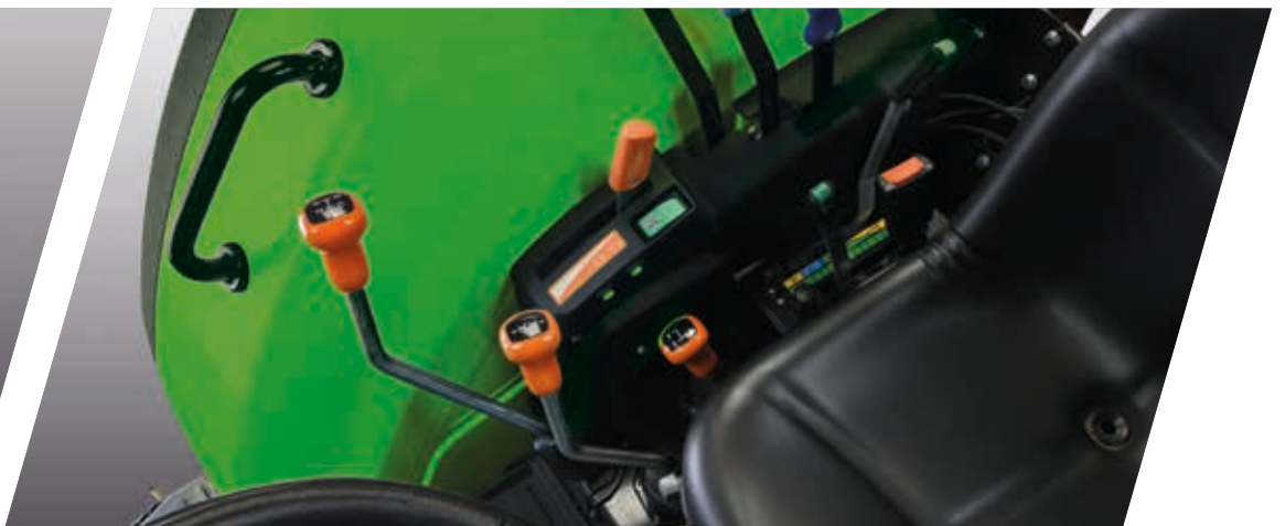
> Neue Anordnung der Steuerung für die Zusatzsteuerventile und das EasyLift-System.
