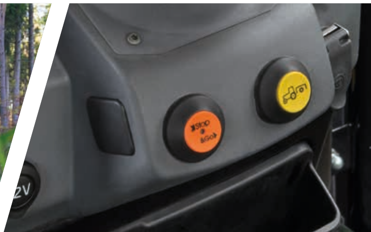
> Elektrohydraulische Zapfwellenzuschaltung bei Modellen mit PowerShuttle
