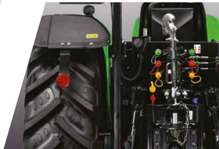
> Steuergeräte mit Durchflussregler und drucklosem Rücklauf.
