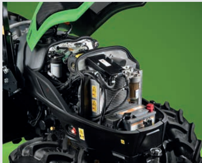
↑ Stufe-V-konforme Motoren mit Common-Rail-Einspritzung und einer Leistung von bis zu 59 PS.
