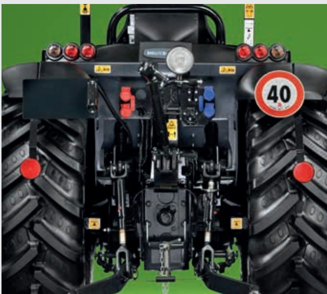
↑ 2 Zapfwellenkonfigurationen und Wegzapfwelle für jeden Einsatzzweck.
