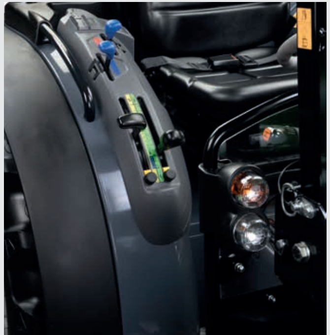
↑ Heckkraftheber mit Zug-, Lage- und Mischregelung.
