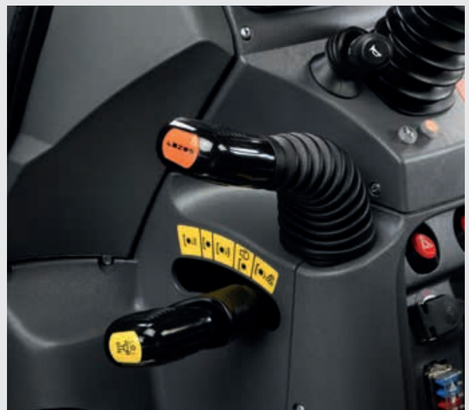
↑ Mechanisches Getriebe mit synchronisierter Wendeschtaltung.
