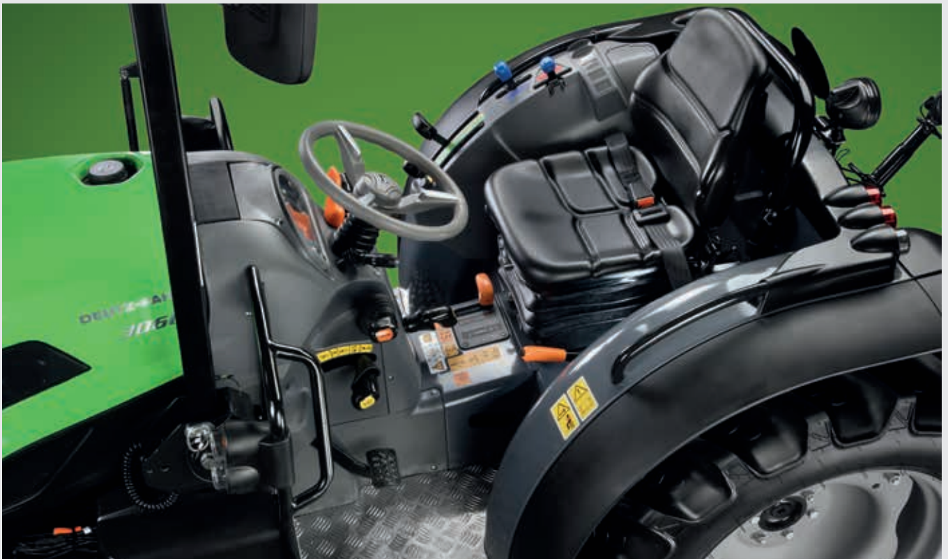
↑ Offene Fahrerplattform auf Silent-Blöcken gelagert, mit klappbarem Überrollbügel.
