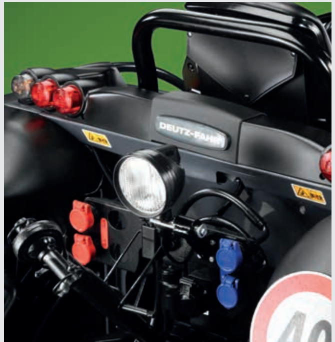
↑ Bis zu 6 Hydraulikanschlüsse im Heck.
